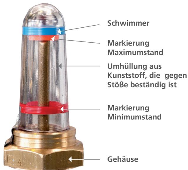
Abb. 10. Ölstandsanzeiger
