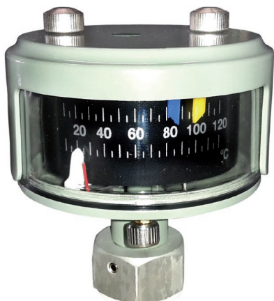
Rys. 13. Typowy wygląd termometru umieszczonego w kieszeni termometrowej.
