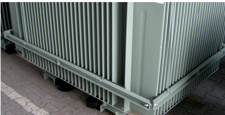
Rys. 25. System belek zabezpieczających fale na czas transportu
