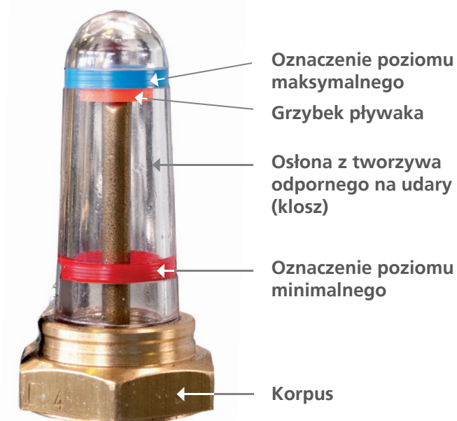
Rys. 10. Wskaźnik poziomu oleju
