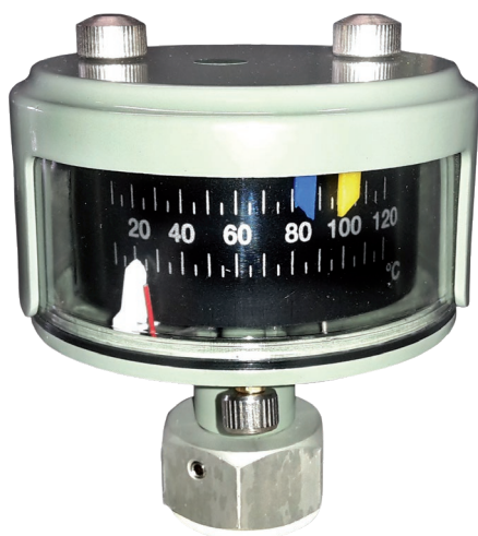
Fig. 13. Aspect standard du thermomètre mis dans une poche de thermomètre
