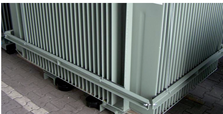
Fig. 25. Système de poutres protégeant les ondes lors du transport.
