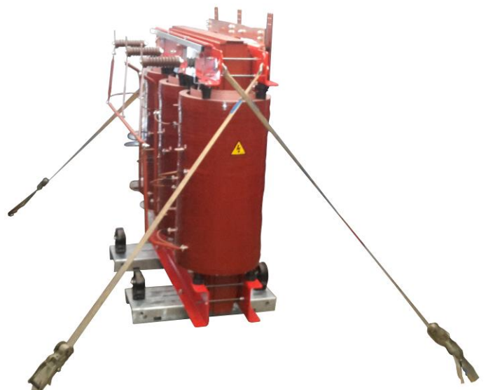
Rys. 20. Transformator przygotowany do transportu na samochodzie
