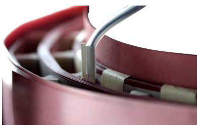
Rys. 8. Prawidłowo umieszczony czujnik w cewce DN
