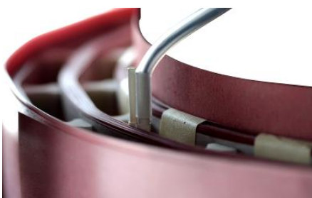
Rys. 8. Prawidłowo umieszczony czujnik w cewce DN
