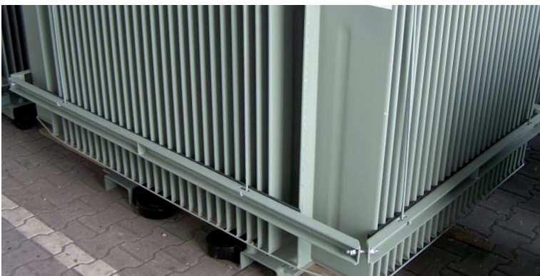
Abb. 25. Trägersicherungssystem während des Transports
