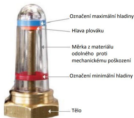
Obr. 10: Indikátor hladiny oleje
