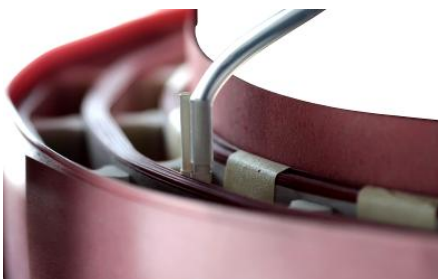
Rys. 8. Prawidłowo umieszczony czujnik w cewce DN
