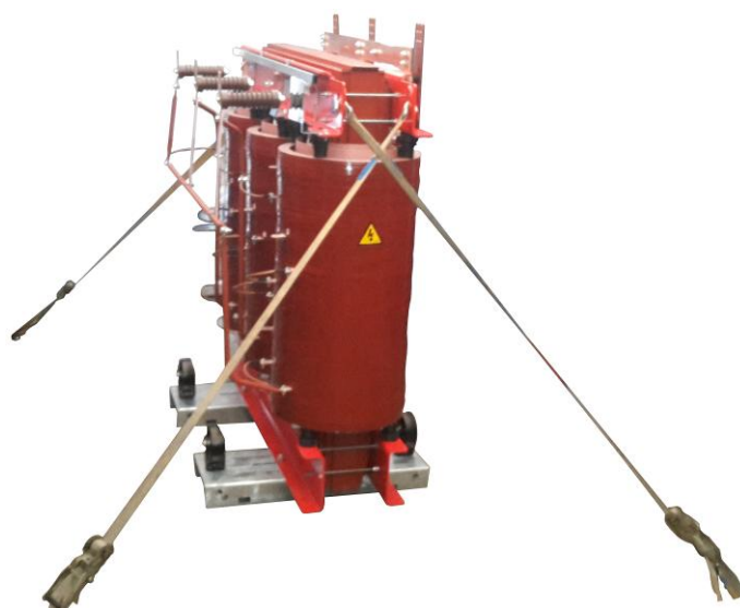
Rys. 19. Transformator przygotowany do transportu na samochodzie
